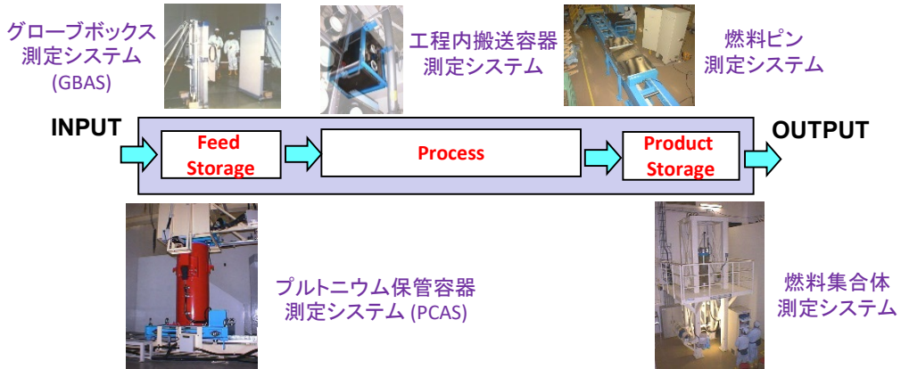
プルトニウム燃料製造施設の「非立合型非破壊検認装置」と「封じ込め・監視システム」
